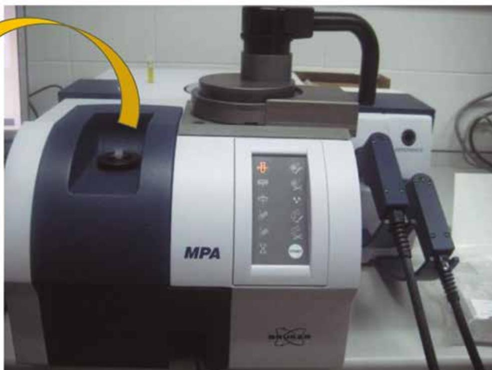
Figura 2: Instrumento FT-NIR MPA utilizado en las calibraciones. Foto: UCO, IAS-CSIC e IFAPA.
